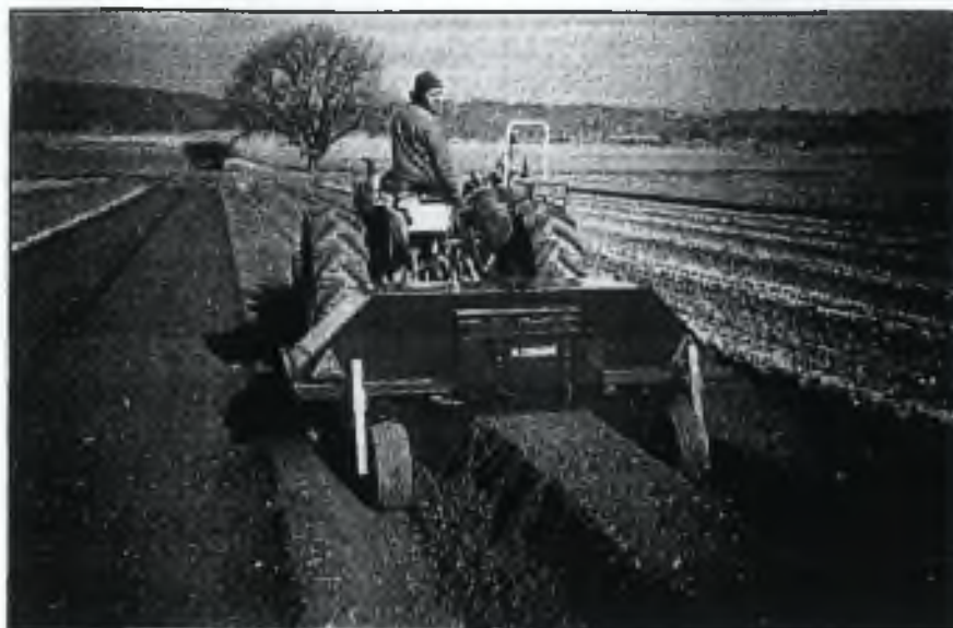
Εικ. 26 Μηχάνημα κατάλληλο για τη δημιουργία των σαμαριών.
