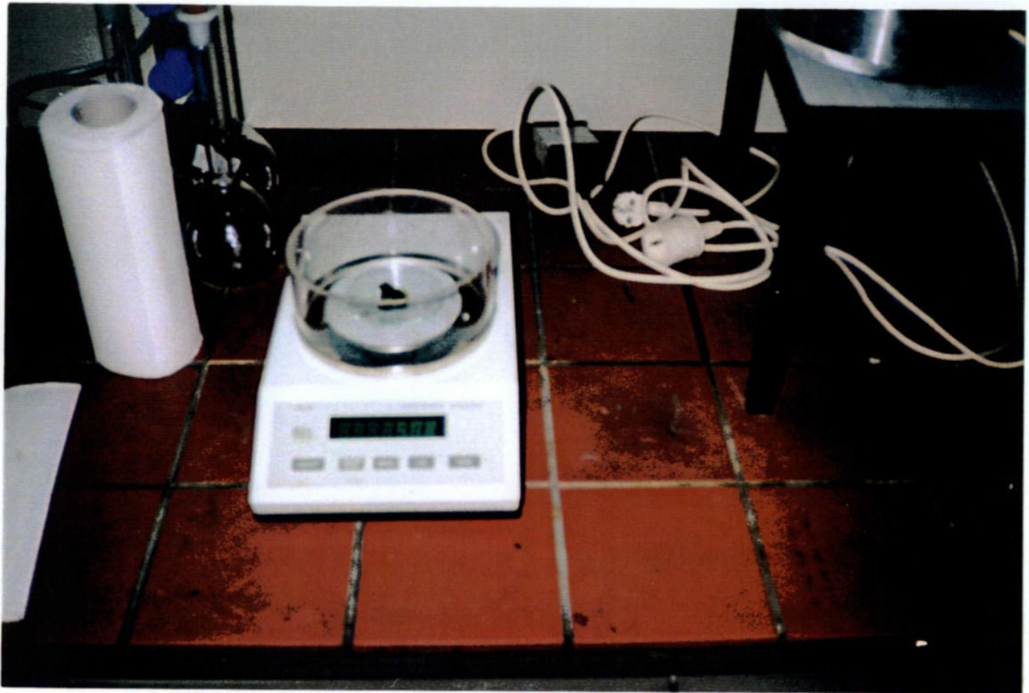
Ζύγισμα δείγματος με ζυγαριά ακριβείας (Bel engineering)
