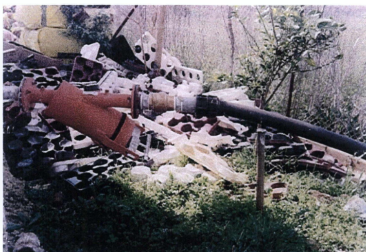
Εικόνα 55: Απλό φίλτρο σίτας για το νερό της γεώτρησης
