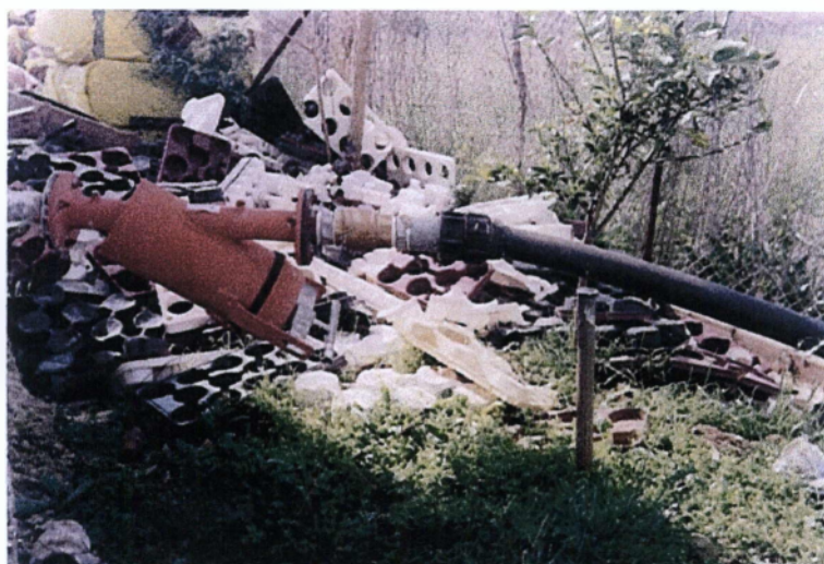
Εικόνα 60: Απλό φίλτρο σίτας με ευθύγραμμη ροή, μέσα από το οποίο περνά το νερό της γεώτρησης
