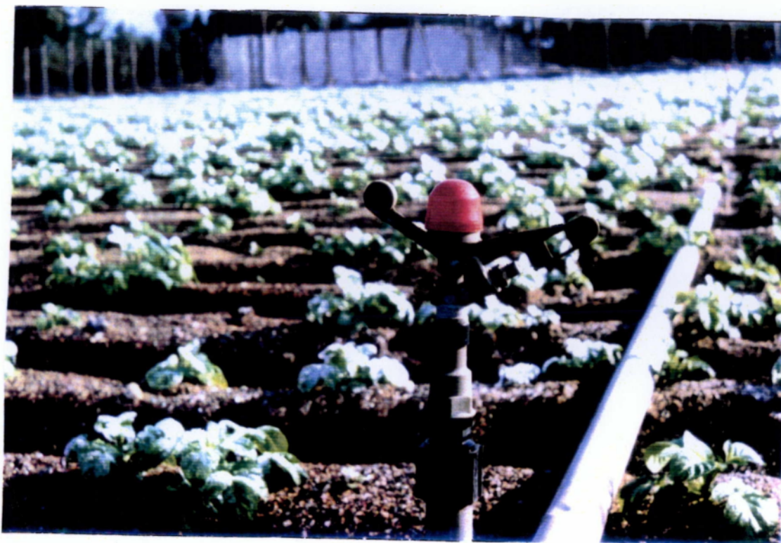
Εικόνα 15: Μπεκ τεχνητής βροχής για προστασία από τον παγετό. Χαρακτηριστικό του συγκεκριμένου μπεκ είναι η πλαστική θήκη που φέρει στο επάνω μέρος της κεφαλής, ώστε να καλύπτει το ελατήριο που δίνει την κίνηση και να μην παγώνει κατά τη διάρκεια του παγετού.
