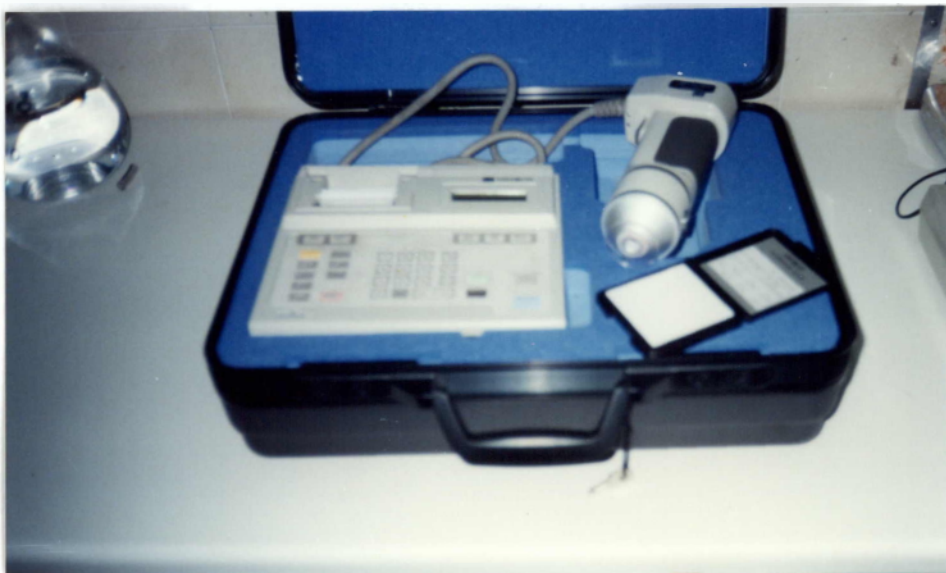
Φωτ. 1. Φορητό χρωματόμετρο Minolta CR-300
