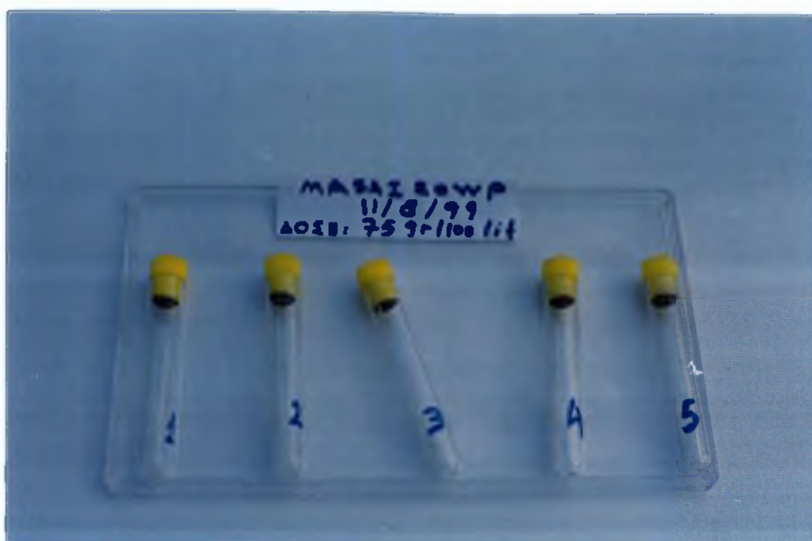
Εικόνα 22. Διαδικασία βιοδοκιμών μέσα σε γυάλινους διαφανείς σωλήνες.
