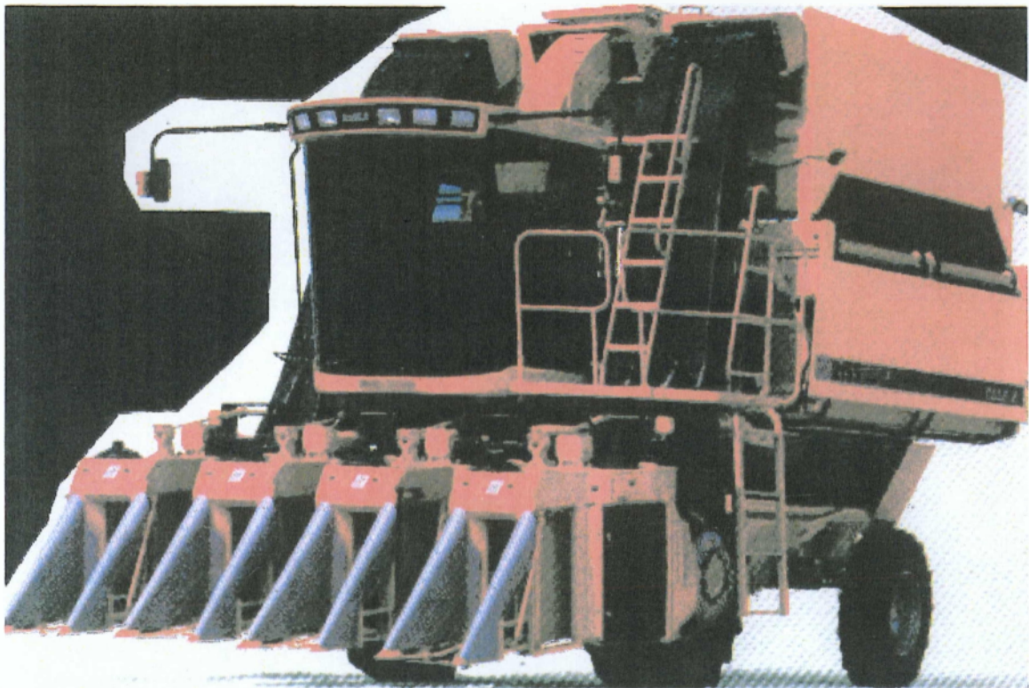
Εικόνα 9. Μια βαμβakoσυλλεκτική μηχανή τεσσάρων σειρών
