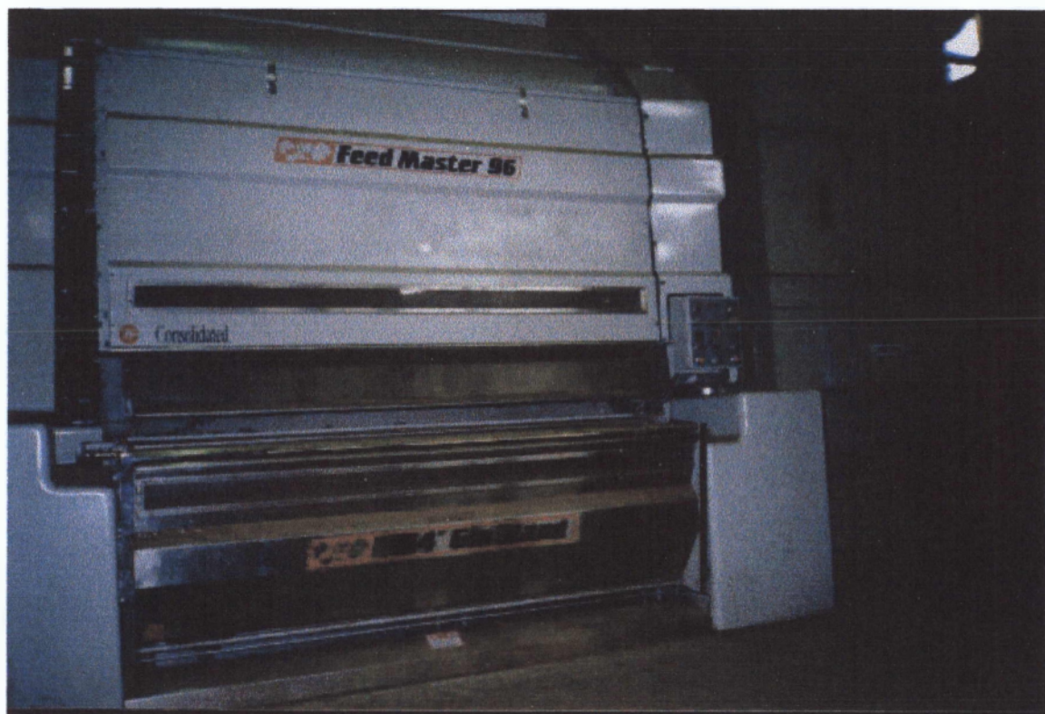
Εικόνα 34. Εκκοκκιστική μηχανή με πριόνια
