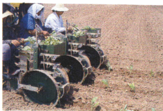
Εικ.33 Μεταφύτευση με φυτευτική μηχανή τριών σειρών
