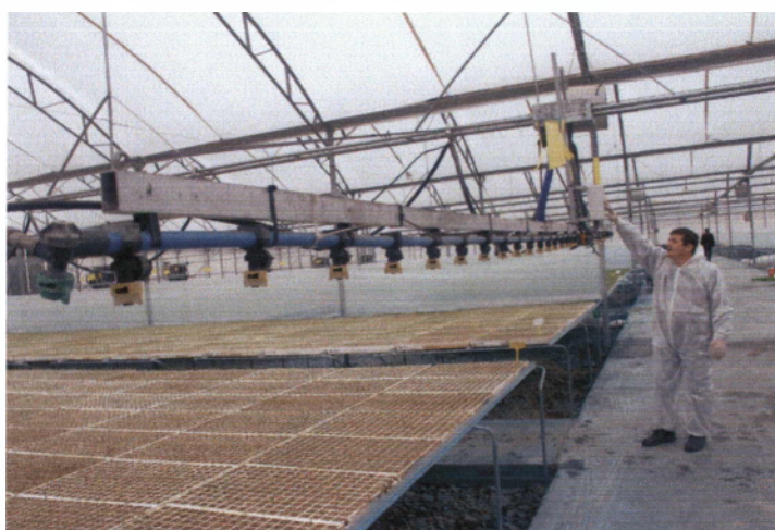
Εικόνα 10: Σύστημα αυτόματης άρδευσης με μπούς.
