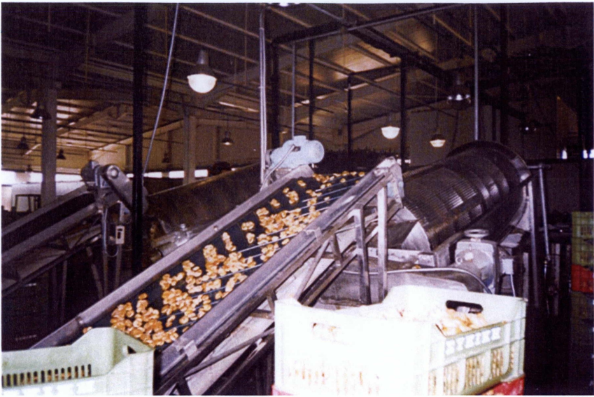
Φωτ. 34: Αναβατόριο που οδηγεί στο πλυντήριο
