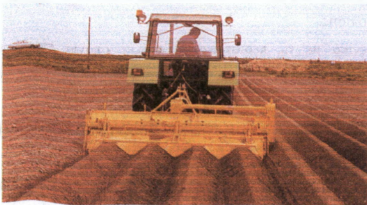
Φρέζα με διαμόρφωση οπίσθιου τμήματος για σχηματισμό αναχωμάτων ΦΩΤ 6
