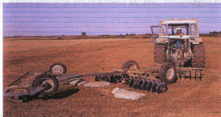
Δισκοσβάρνα ακολου- θούμενη από ιδιοκατα- σκευή ισοπεδοτή και κυλίνδρου ΦΩΤ 9
