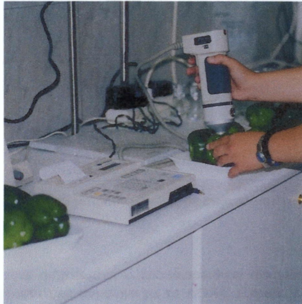
Εικόνα 6 Χρωματόμετρο για τον προσδιορισμό του χρώματος των πιπεριών
