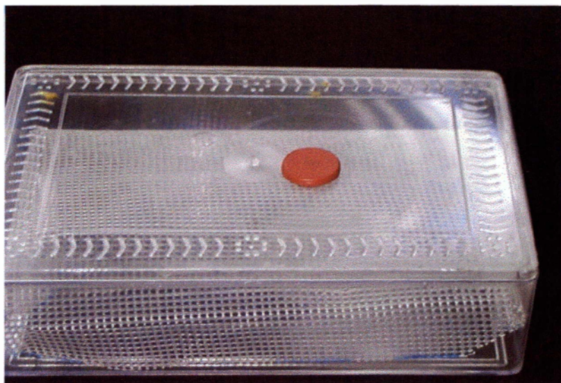
Εικόνα 26. Πλαστικός θάλαμος από σκληρό πλαστικό όγκου 930,6\text{cm}^3
