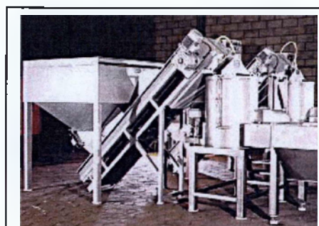
Εικόνα 75. Αποφλοιωτής συνεχούς λειτουργίας με αυτόματη τροφοδοσία
