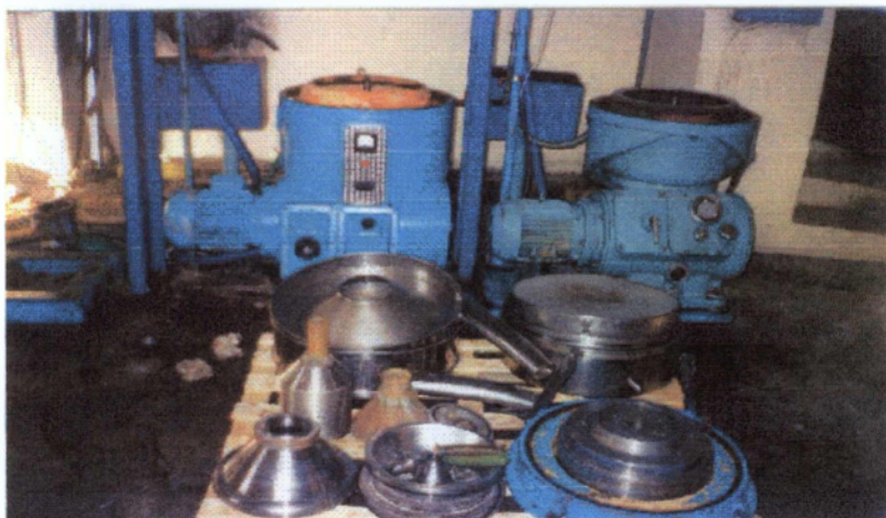
Εικόνα 8.3 Στοιχεία Ελαιοδιαχωριστήρα μετά από συντήρηση
