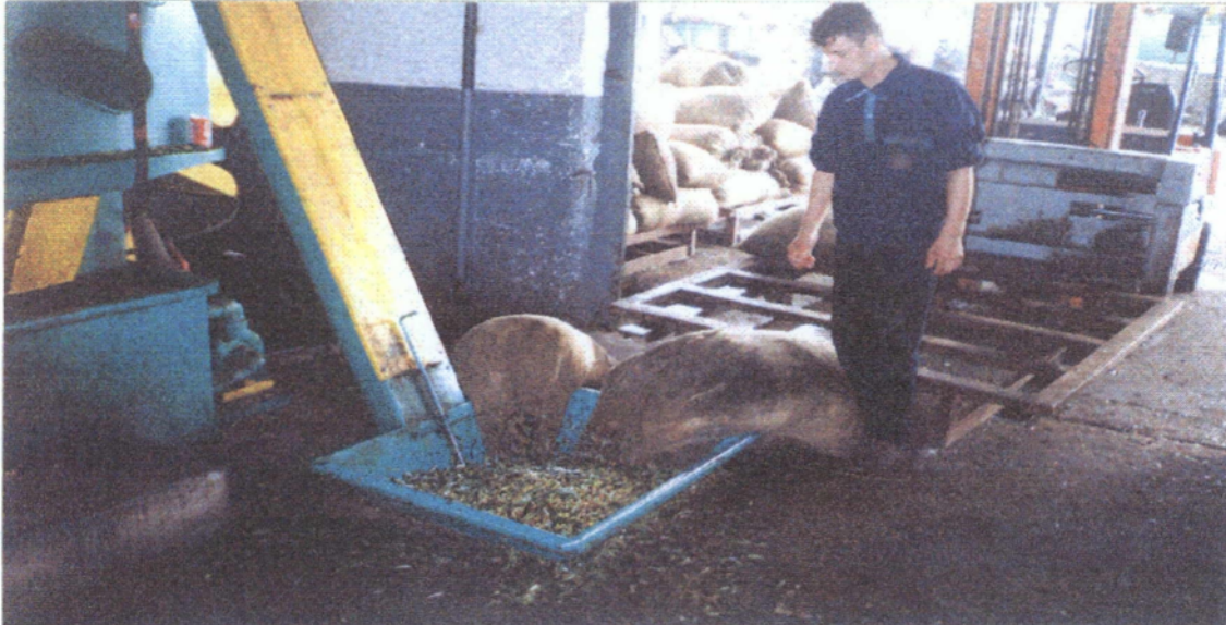
Εικόνα 8.2: Παραλαβή ελαιοκάρπου και προώθηση για το αναβατήριο
