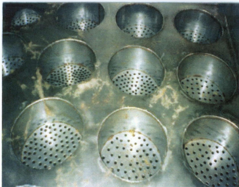
Φωτο 4.1: Δεξαμενή φιλτραρίσματος ελαιολάδου πριν την τυποποίηση
