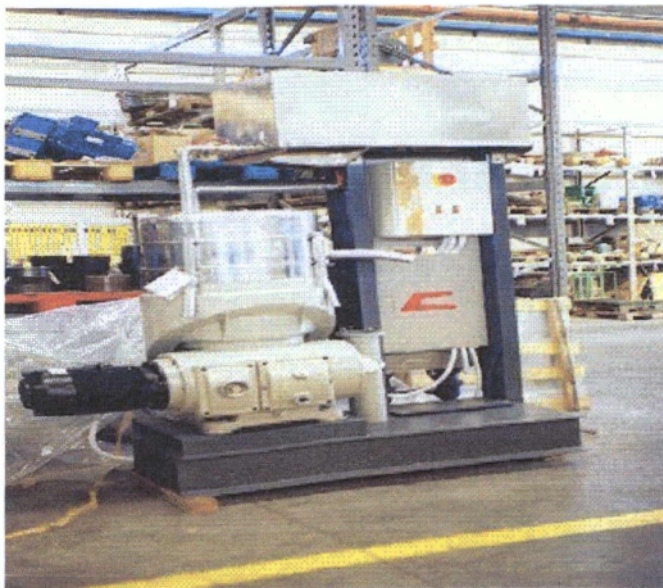
ΦΩΤΟ 1 : ΕΛΑΙΟΔΙΑΧΩΡΙΣΤΗΡΑΣ BARRACANE ΤΥΠΟΣ BARI 3000 ΜΕ ΩΡΙΑΙΑ ΑΠΟΔΟΣΗ 2,500 kg
