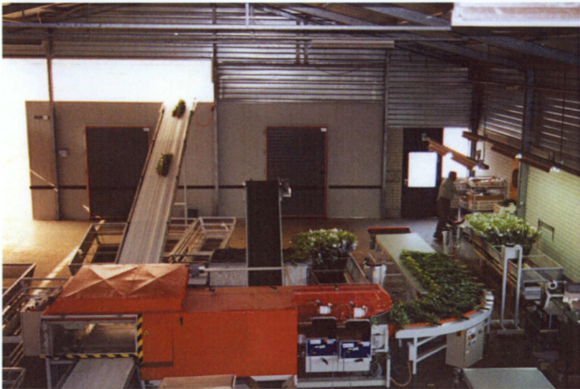
Εικόνα 2 Μηχάνημα συγκέντρωσης κομμένων λουλουδιών και συσκευασίας.
