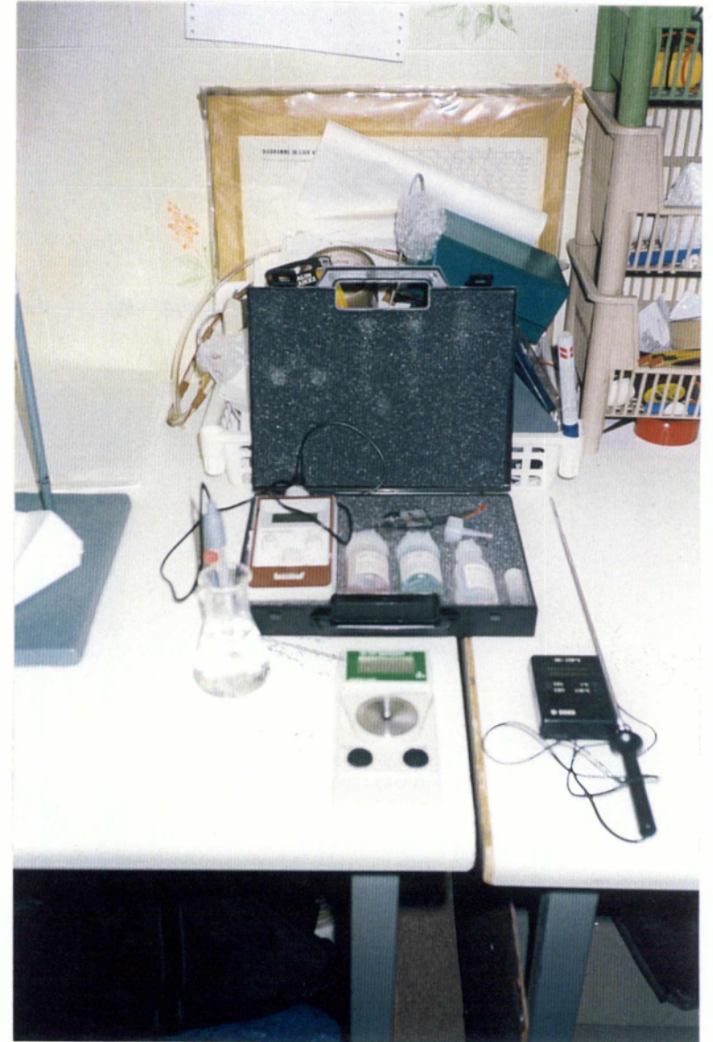
Φωτ.4 Επιτραπέζιος ζυγός ακριβείας (αριστερά), πεχάμετρο, διαθλασίμετρο, θερμομέτρο (δεξιά).
