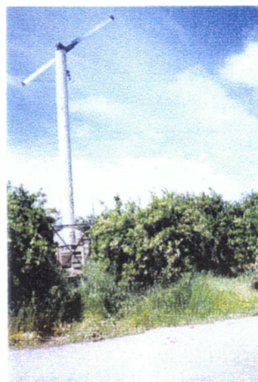
Πετρελαιοκίνητος ανεμιστήρας ισχύος 150 HP
