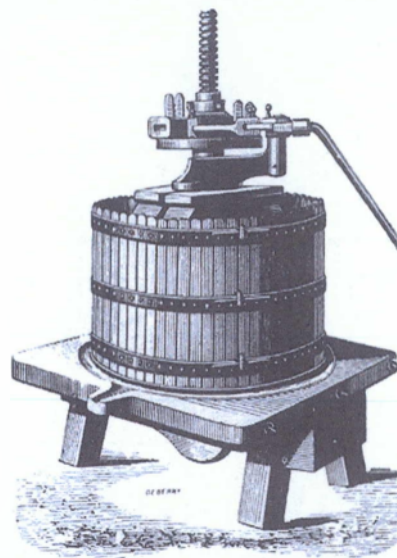
Εικόνα 29: Χειροκίνητο κατακόρυφο πιεστήριο (verin).
