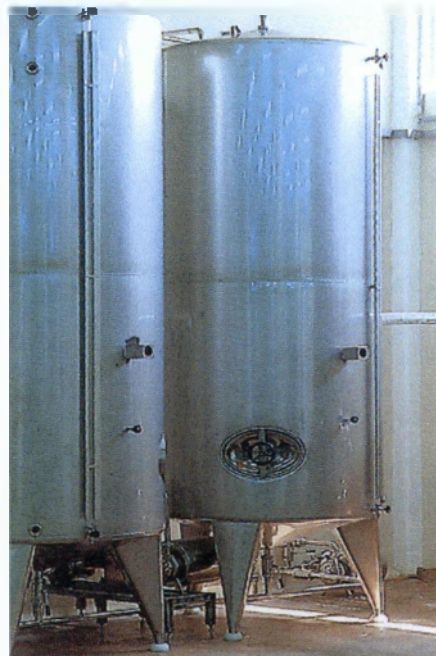
Εικόνα 33: Ψυχόμενος οινοποιητής ερυθράς οινοποίησης. Seraco Mechanical S.A.
