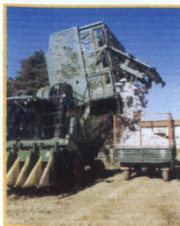
2. Συλλεκτική μηχανή βαμβακιού. Αδίσιασμα συσπόρου σε πλατφόρμα
