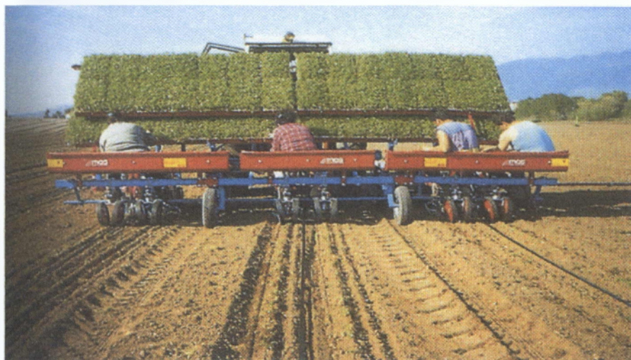
Εικ. 3.6 Μεταφύτευση Τομάτας με μεταφυτευτική μηχανή.
