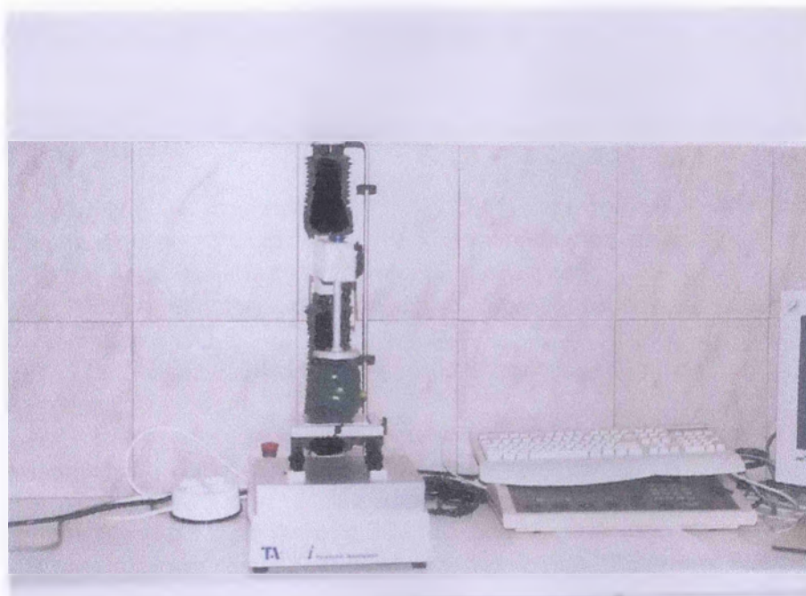
Εικόνα 4: TEXTURE ANALYSER για την μέτρηση της υφής και της σκληρότητας της πιπεριάς.
