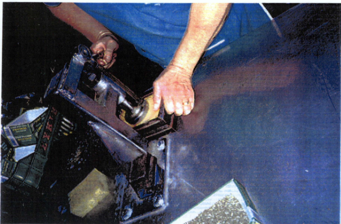
Εικ. 35: Τοποθέτηση μεταλλικού καλουπιού σε χειροκίνητη πρέσσα Πηγή: Προσωπικό αρχείο
