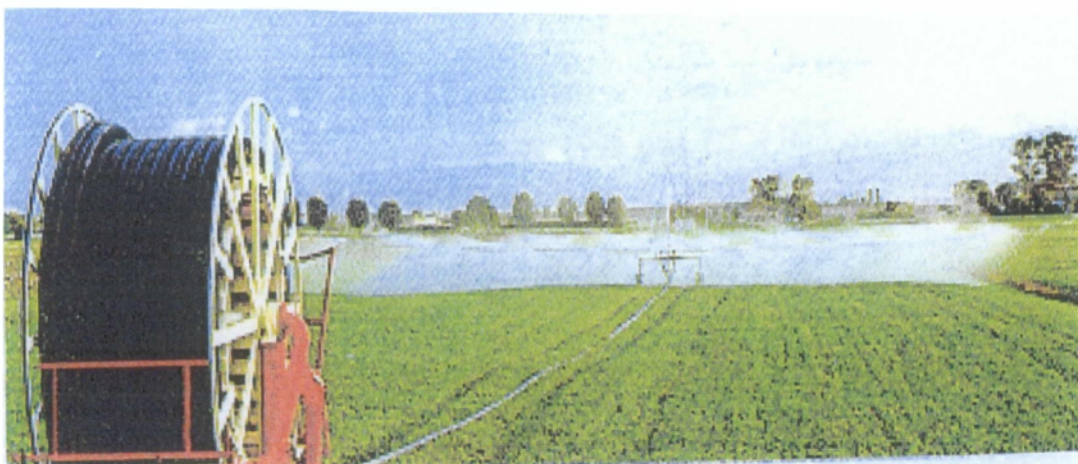
Εικόνα 6.4 : Αυτοκίνητο σύστημα άρδευσης με ράμπα εν ώρα λειτουργίας
