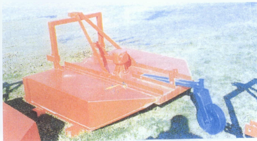
Εικόνα 3.1. Στελεχοκόπτης με μαχαίρια κοπής οριζόντια περιστρεφόμενα
