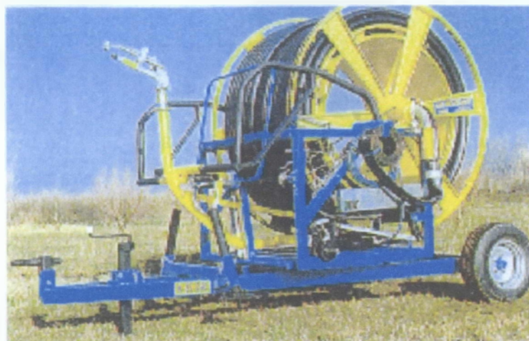
Εικόνα 6.1: Αυτοκίνητο συγκρότημα αρδύσεως με κανόνι
