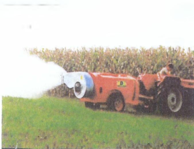
Εικόνα 3.21: Ψεκαστικό υψηλής πίεσεως με κατευθυνόμενο ρεύμα αέρα εν ώρα λειτουργίας
