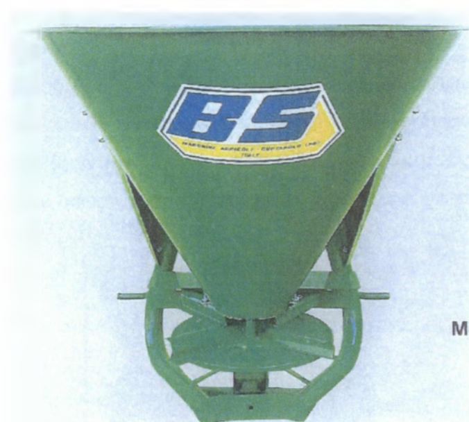
Εικόνα 3.5 Λιπασματοδιανομέας με οριζόντια περωτή
