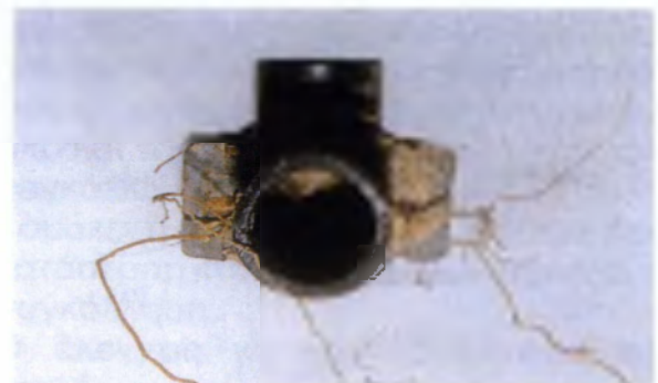
Εικόνα 5.6 Η ρίζα έχει ανοίξει τη σέλα και στραγγαλίζει το σωλήνα
