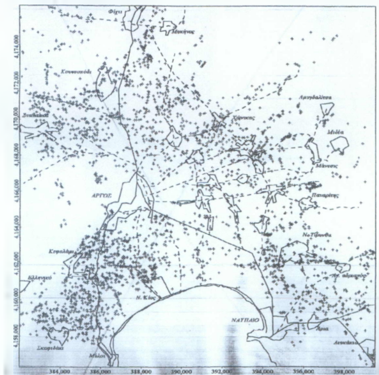
Σχήμα 5.2 Σύγχρονη κατανομή γεωτρήσεων στην περιοχή του Αργολικού πεδίου ((Πηγή: Νομαρχία – Αργολίδα, Τμήμα Εγγείων Βελτιώσεων)
