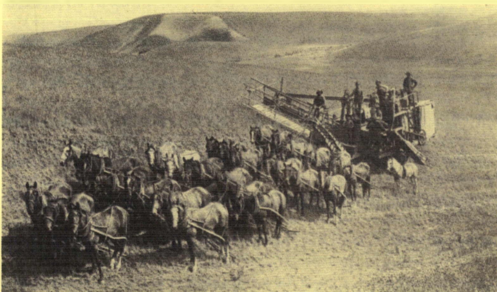
Ιπποκίνητη θεριζοαλωνιστική μηχανή του 1904.
