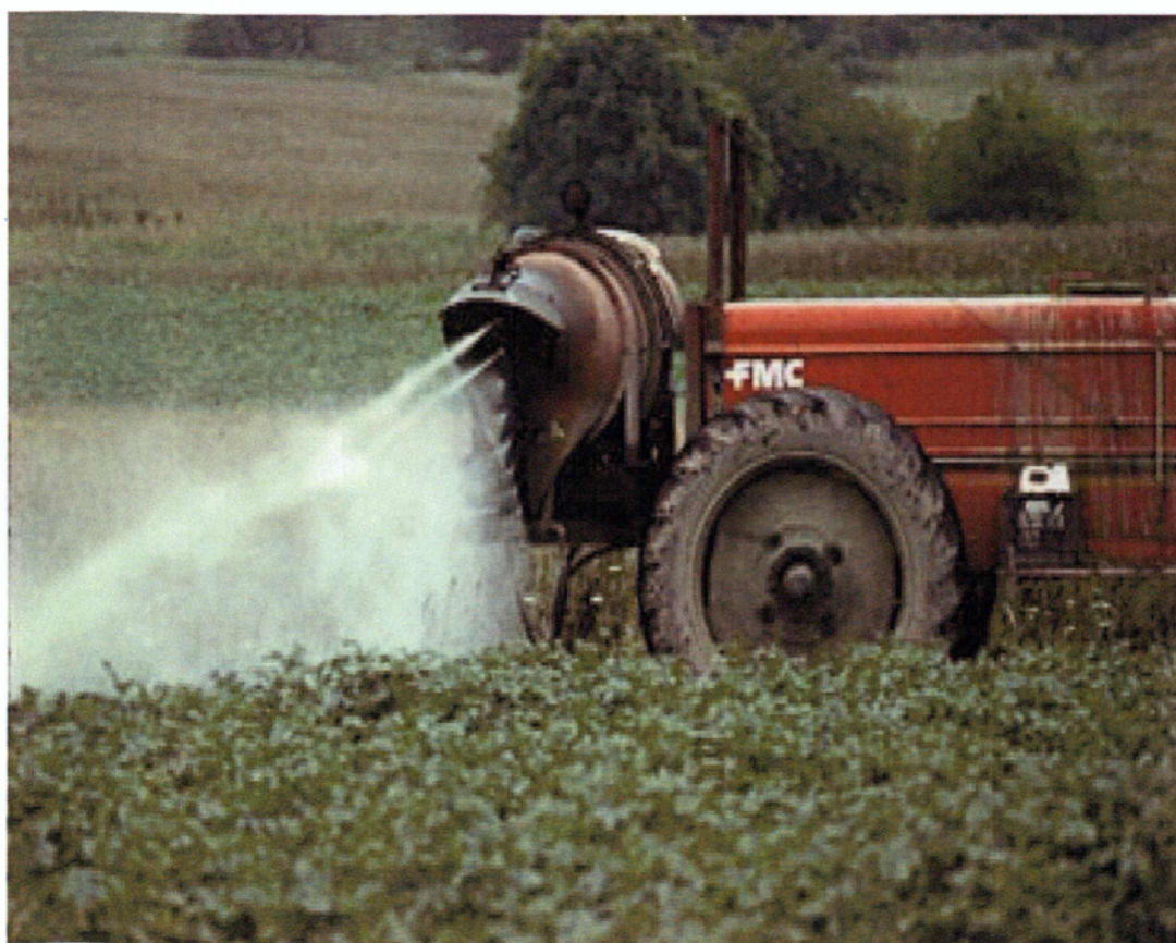
Εικόνα 3. ψεκασμός μέσου όγκου με φερόμενο σε ανελκυστήρα ψεκαστικό μηχάνημα
