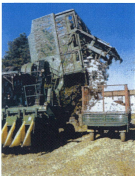
Εικ. 3.6.2 α. Άδειασμα συσπόρου σε πλατφόρμα. β. Συλλεκτική μηχανή βαμβακιού.
