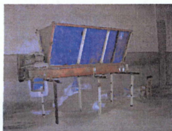
Εικόνα 9: Μηχανισμός που φτιάχνει τις ζωοτροφές σε κοκκοειδή μορφή
