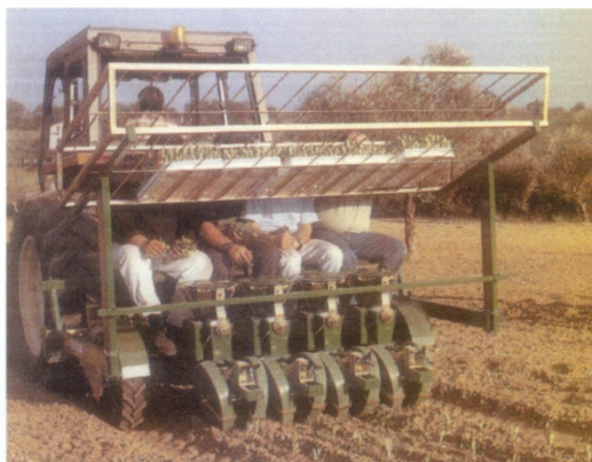
Εικόνα 4.3. Σχηματική παράσταση ημιαυτόματης μηχανής μεταφύτευσης με συγκλίνοντες ελαστικούς τροχούς (Accord).
