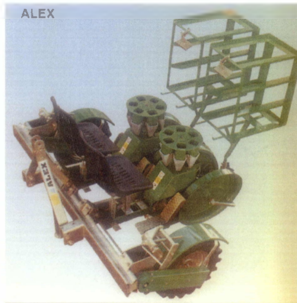
Εικόνα 4.5. Ημιαυτόματη μεταφυτευτική με μεταφορική ταινία που φέρει λαβίδες (Colchester tillage).
