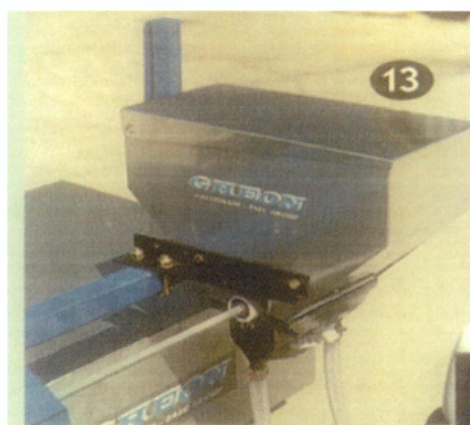
Εικόνα 3.7. Σχηματική παράσταση μηχανισμών διανομής φυτοφαρμάκων των μηχανών σποράς ακριβείας.
