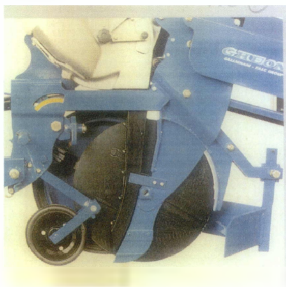
Εικόνα 3.4. Μηχανισμοί διάνοιξης αυλακιάς σπαρτικών μηχανών ακριβείας.
