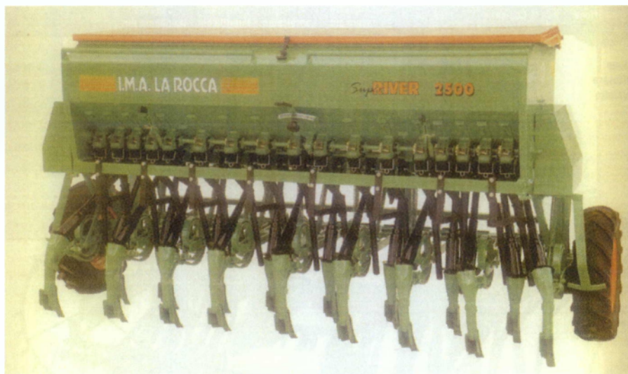
Εικόνα 1.6. Σύγχρονες σπαρτικές με κοινά δοχεία σπόρου, πλάτους ίσου με το πλάτος σποράς.
