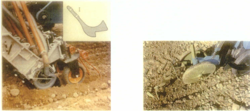
Εικόνα 3.6. Ρύθμιση του βάθους σποράς με τροχούς
