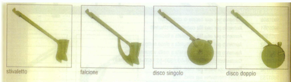
Εικόνα 1.11. Σχηματική παράσταση συστημάτων διάνοιξης αυλακιάς των σπαρτικών μηχανών.
