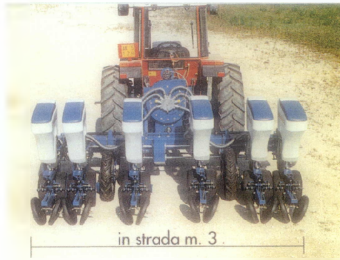
Εικόνα 3.1. Μηχανισμοί πνευματικής σπαρτικής σποράς ακριβείας.
