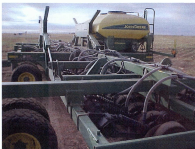
Εικόνα 3.10. Η σπορά γίνεται με ειδικές μηχανές που σπέρνουν με ελάχιστη αναμόχλευση του εδάφους
