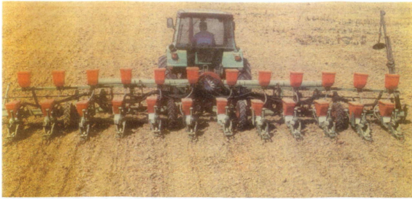
Εικόνα 1.5. Σύγχρονη σπαρτική με ανεξάρτητα για κάθε σειρά δοχεία σπόρου. Η μηχανή φέρει επίσης ανεξάρτητα δοχεία αγροχημικών (πίσω) και ανά δυο γραμμές δοχείο λιπάσματος (εμπρός).
