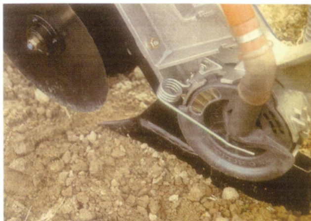
Εικόνα 2.5. Διασπαρτικό σύστημα με τροχούς διπλής ενέργειας.
