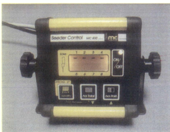
Εικόνα 2.14. Πίνακας οργάνων ελέγχου λειτουργιών σπαρτικής μηχανής (Massey Ferguson).
