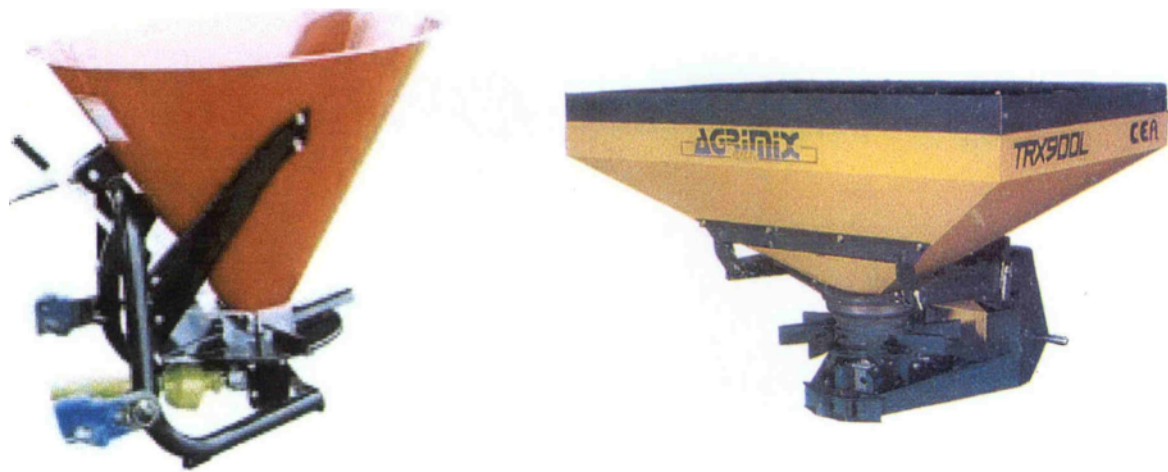
Εικόνα 29. Λιπασματοδινομέας με οριζόντιο περιστρεφόμενο δίσκο.
