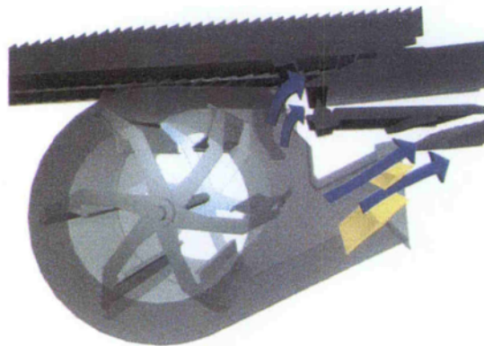
Εικόνα 49: Ανεμιστήρας που παρέχει σταθερή ροή αέρα.
