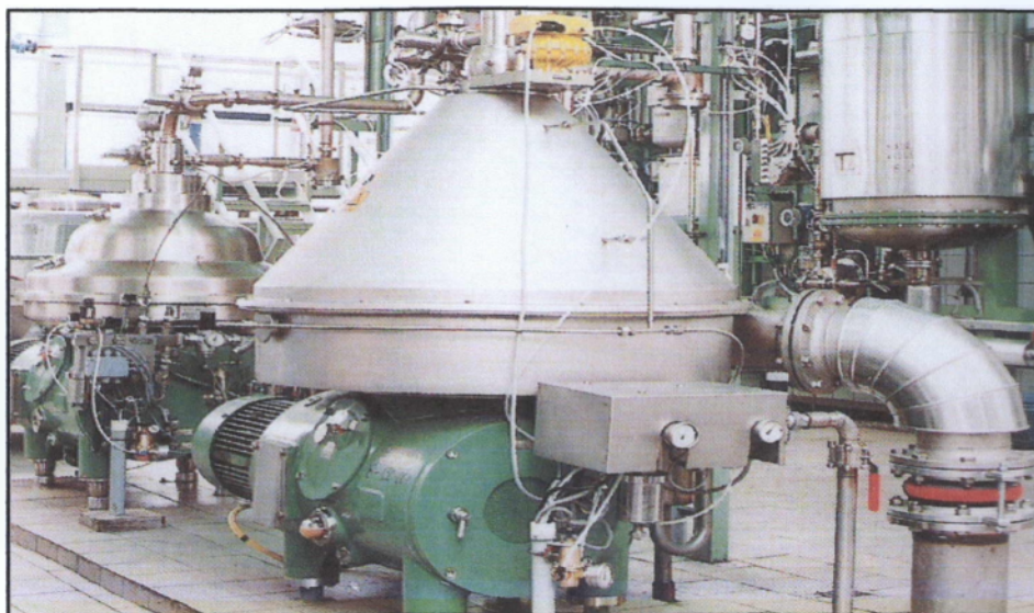
Εικόνα1.4: Σύγχρονος ειδικός διαχωριστήρες για ραφινάρισμα ελαιολάδου
