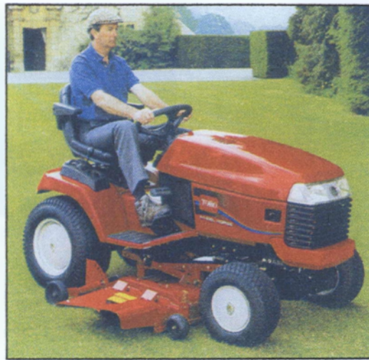
Χλοοκοπτικό μηχανήμα περιστροφικού τύπου για το κούρεμα μεγάλων επιφανειών (πάρκα κλπ)
