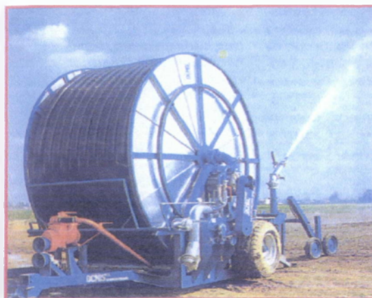
Εικόνα 2.2.α καρούλι με τυλιγμένο τον πλαστικό σωλήνα με ένα εκτοξευτήρα
