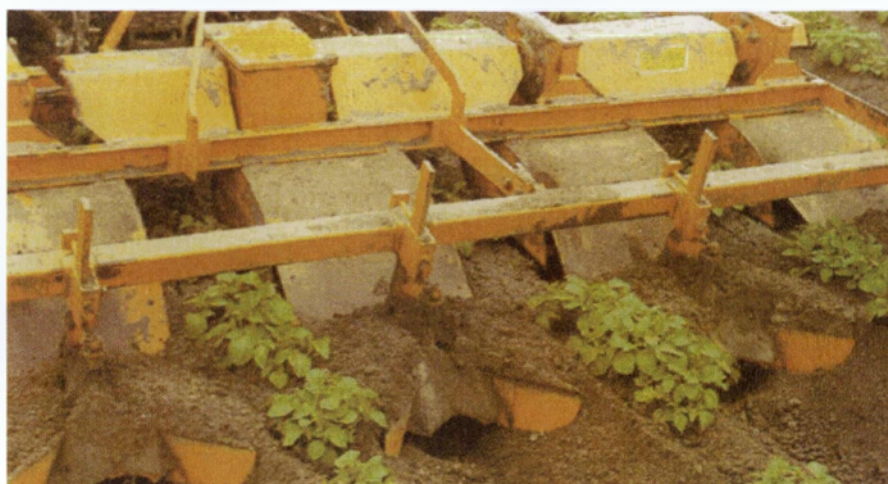
Εικόνα 13. Ο μηχανοκίνητος αυλακωτήρας που χρησιμοποιήθηκε για το παράχωμα της συγκεκριμένης καλλιέργειας πατάτας Πηγή: Προσωπικό αρχείο
