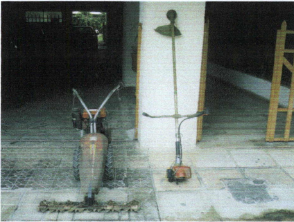
Εικόνα 15. Αριστερά χορτοκοπτικό με ψαλίδια και δεξιά καταστροφέας χόρτων (σβουράκι).
