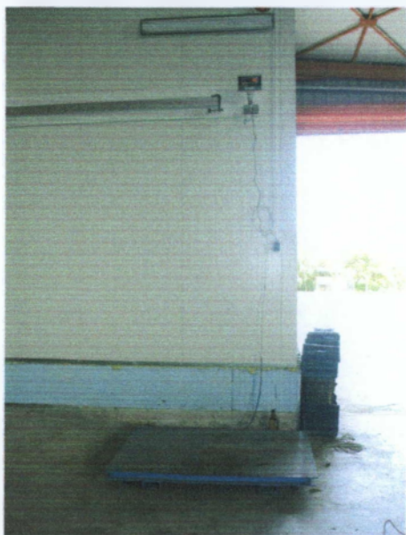
Εικόνα 29. Στάδιο ζυγιστηρίου (ηλεκτρονική ζυγαριά των 3 τόνων).
