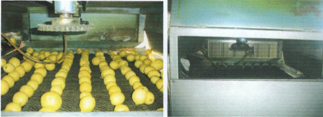
Εικόνα 35,36. Αριστερά στάδιο βουρτσίσματος και κηροποίησης λεμονιών και δεξιά κύλινδροι με βούρτσες.
