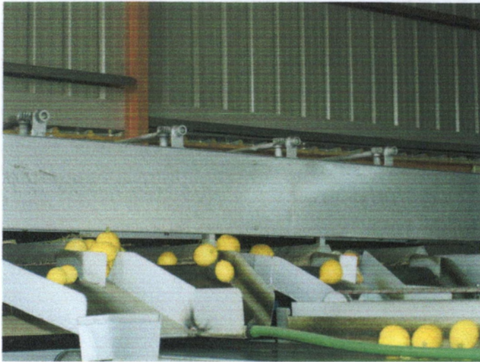
Εικόνα 38. Στάδιο μηχανικής διαλογής λεμονιών.
