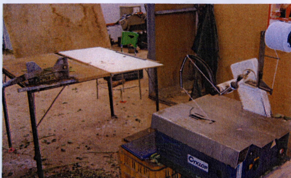
Εικόνα 25. Στη φωτογραφία διακρίνουμε αριστερά το πάγκο κοπής τριαντάφυλλων στο ίδιο μήκος και δεξιά το μηχάνημα με οποίο δένονται τα τριαντάφυλλα σε δέματα.
