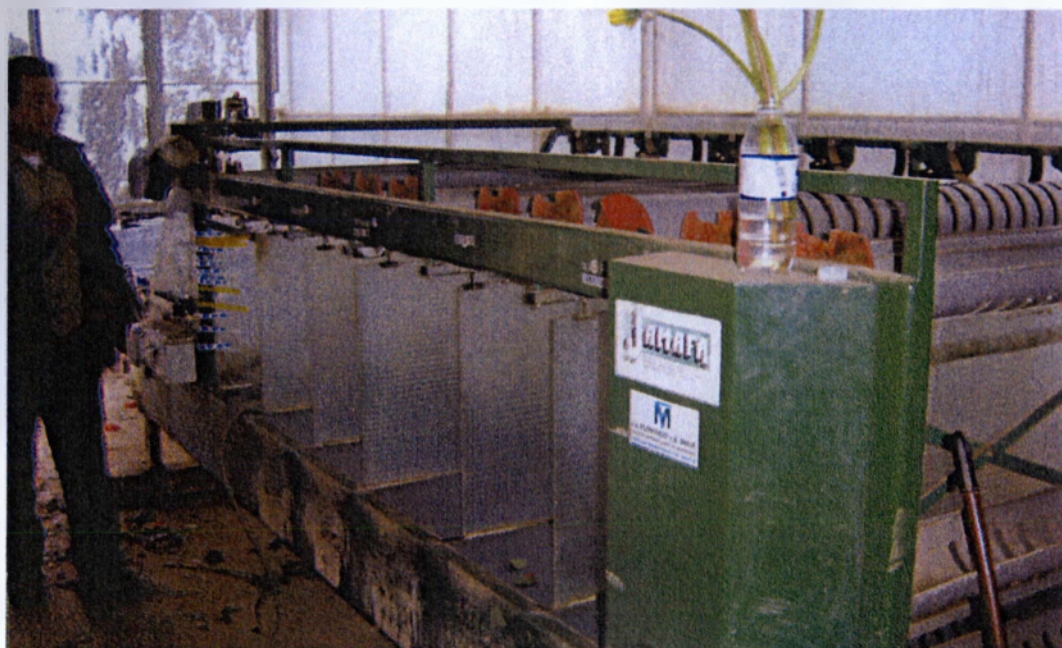
Εικόνα 24. Σύγχρονο μηχανήμα διαλογής κομμένων ανθέων τριανταφυλλιάς.
