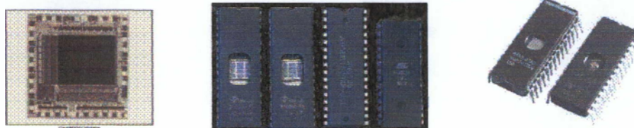
σχήμα 1.9 Στη μνήμη EPROM είναι εγκατεστημένο το πρόγραμμα ελέγχου.
