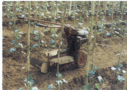
Εικ. 3.7. Μηχανοκίνητο σκαπτικό με αυλακωτήρα στο πίσω μέρος για το άνοιγμα των αυλακιών (Ολύμπιος, 2001).
