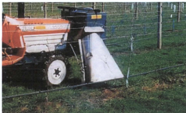
Εικ 5.6:Μηχανισμός που χρησιμοποιεί υπέρθερμο ατμό για την καταπολέμηση ζιζανίων σε αμπελώνα.
