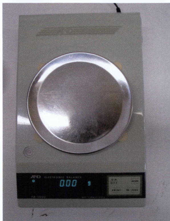
Εικόνα 2.3 : Ηλεκτρονικός ζυγός που χρησιμοποιήθηκε για τη μέτρηση της μάζας των μήλων.
