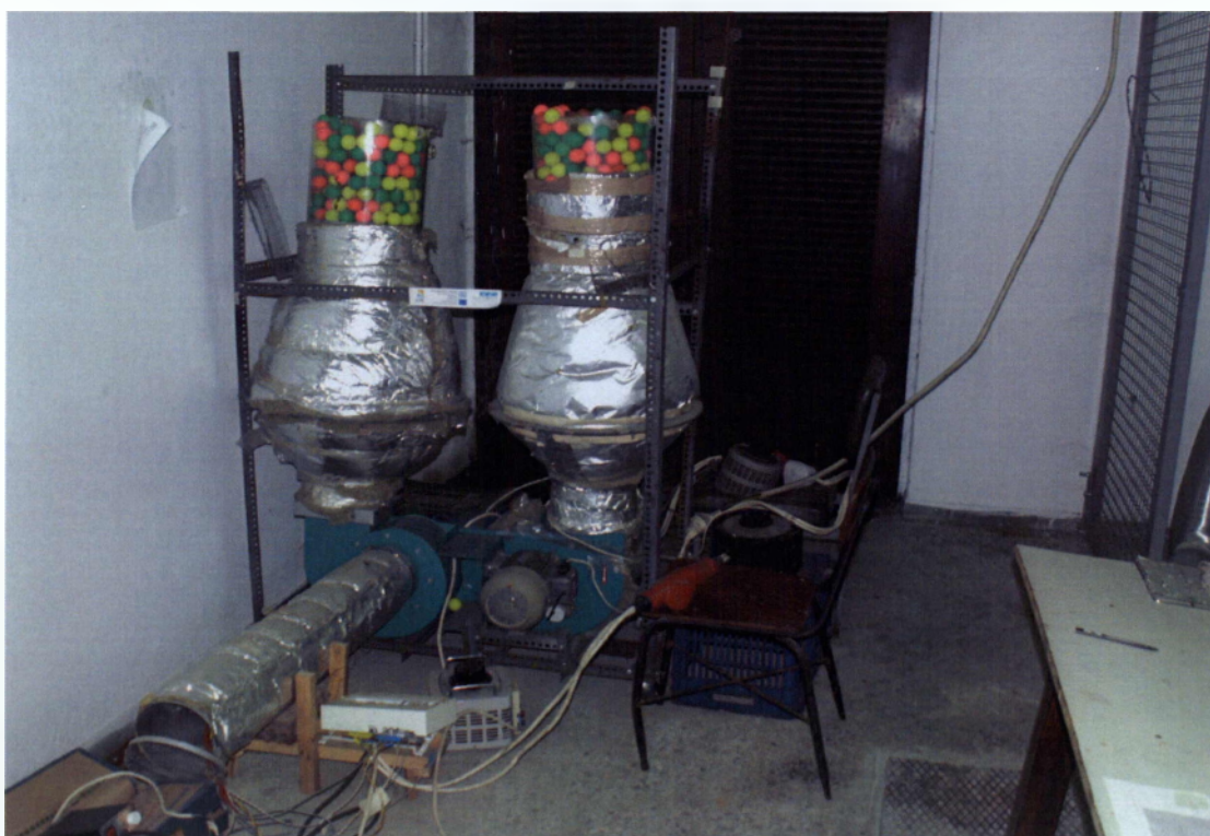
Φωτογραφία 3. Πειραματική εγκατάσταση ξηραντηρίου με ηλεκτρικές αντιστάσεις.
