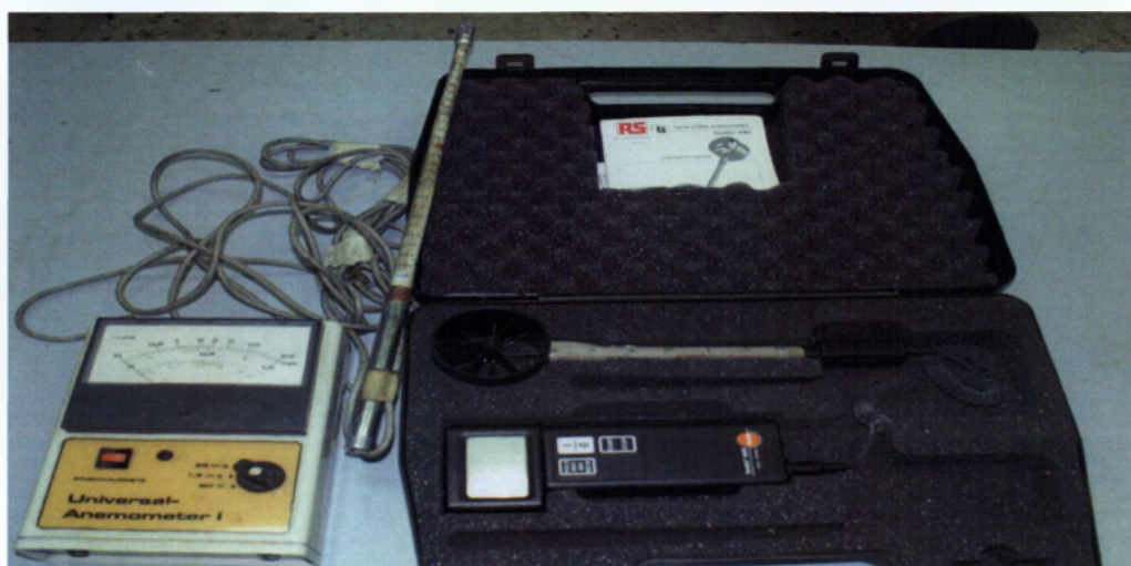
Φωτογραφία 6. Ανεμόμετρο θερμαινόμενου νήματος.
