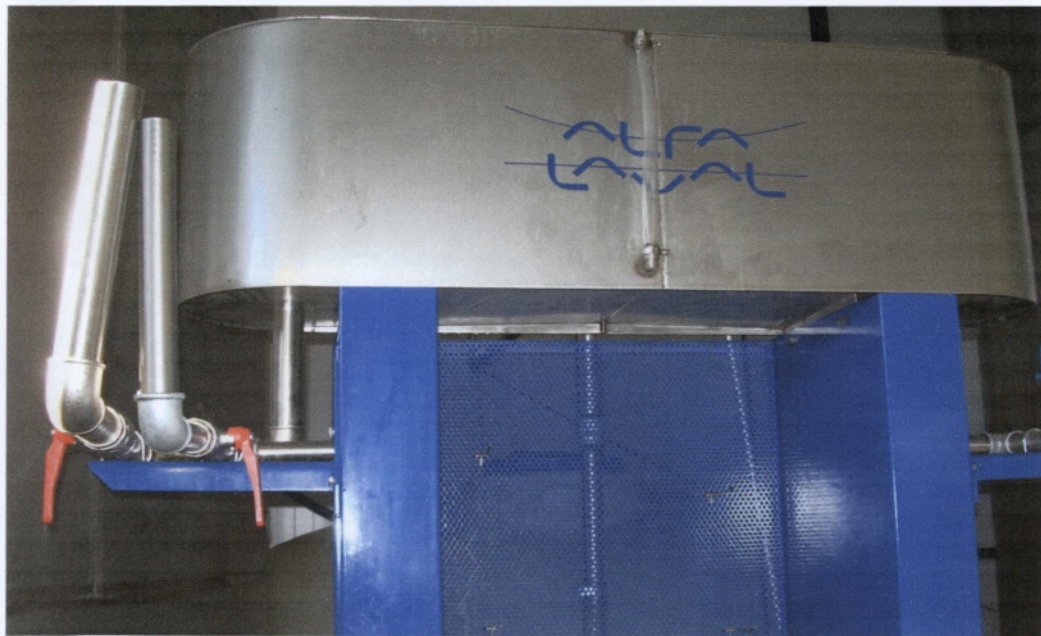
Εικόνα 48 :Κάθετος φυγόκεντρος διαχωριστήρας
