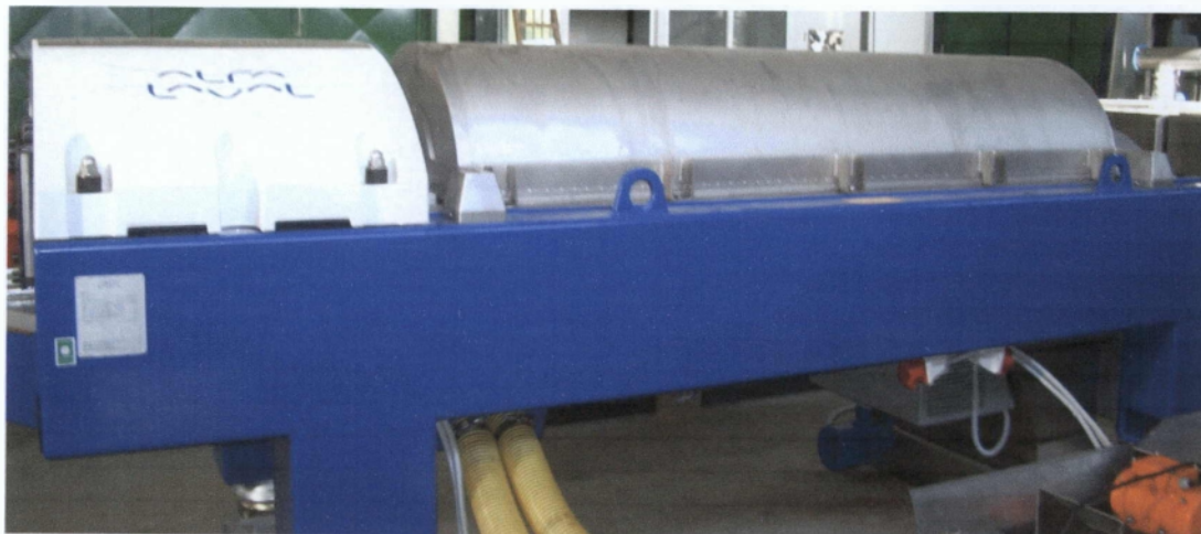
Εικόνα 46 : Φυγόκεντρος οριζόντιος διαχωριστήρας ή decanter(φυγόκεντρικού τύπου ελαιοτριβεία)
