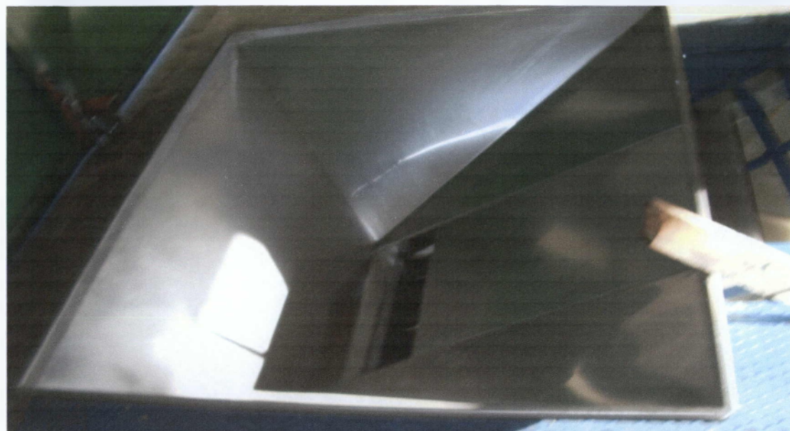
Εικόνα 36 : Χοάνη υποδοχής, στην οποία εισέρχεται ο ελαιοκάρπος για να γίνει η αποφύλλωση
