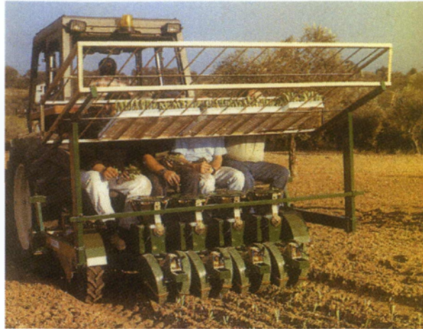
Εικόνα 3.15. Σχηματική παράσταση ημιαντόματης μηχανής μεταφύτευσης με συγκλίνοντες ελαστικούς τροχούς (Accord)
