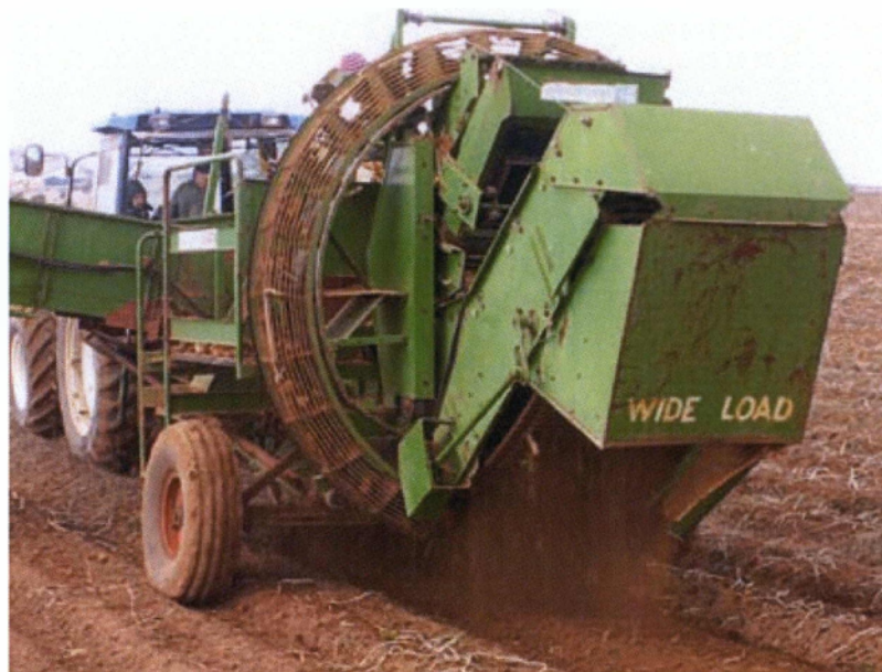
Εικόνα 3.14.Μεταφυτευτική μηχανή συγκομιδή πατάτας
