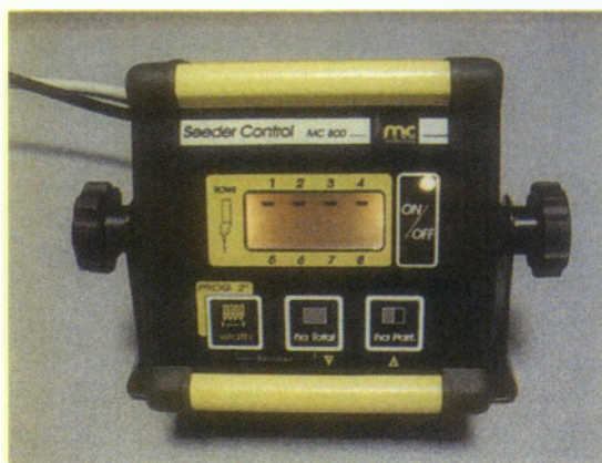
Εικόνα 2.7. Πίνακας οργάνων ελέγχου λειτουργιών σπαρτικής μηχανής (Massey Ferguson)
