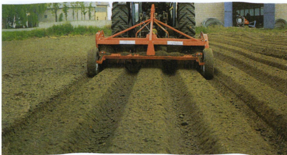
Εικόνα 3.27.Μηχανή φύτευσης καρπουζιού
