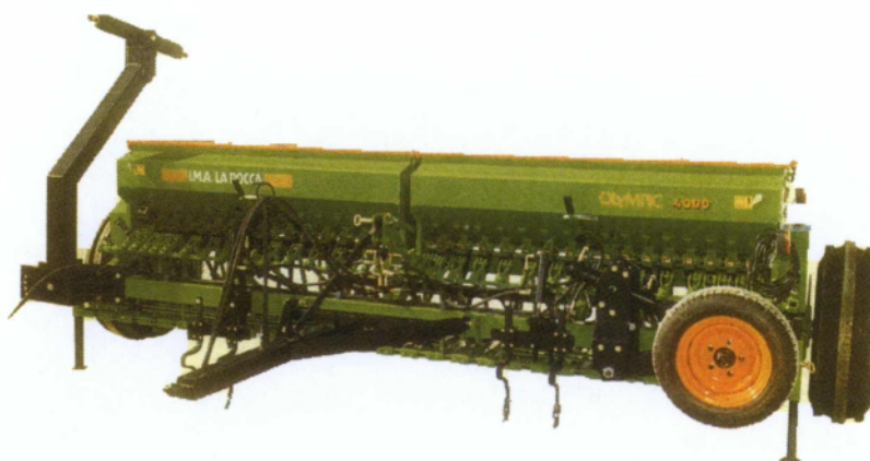
Εικόνα 2.14. Σπαρτική γραμμικής σποράς με τροχούς μεταφοράς
