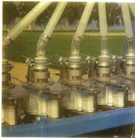
Εικόνα 2.26. Αρχή σπαρτικής γραμμικής σποράς με πολλαπλούς διανομείς και μεταφορά με ρεύμα αέρα. Κάθε διανομέας διανέμει σπόρους σε πολλές σειρές (Kongskilde)
