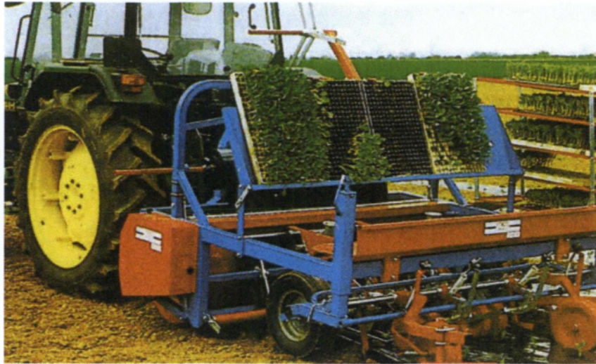
Εικόνα 3.28.Μεταφυτευτική μηχανή καρπουζιού
