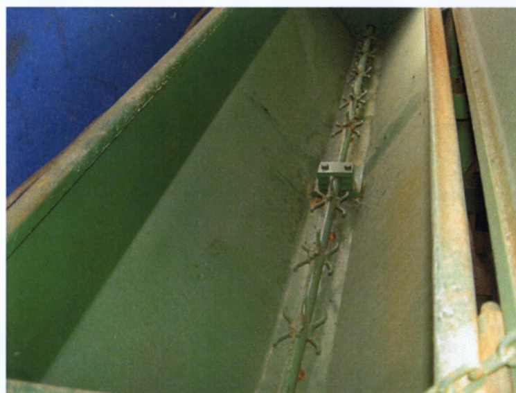
Εικόνα 2.15. Δοχείο Σπαρτικής Μηχανής
