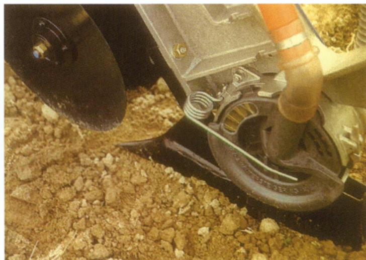
Εικόνα 2.20. Διασπαρτικό σύστημα με τροχούς διπλής ενέργειας
