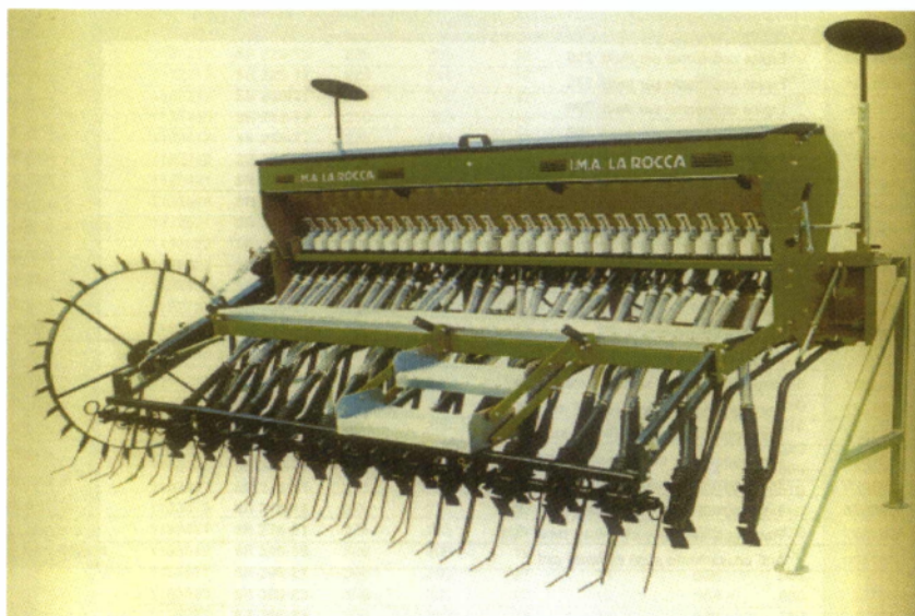
Εικόνα 2.17. Κλασική μηχανή γραμμικής σποράς
