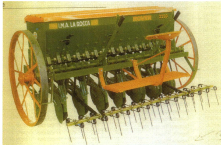
Εικόνα 2.28. Μηχανή γραμμικής κατευθείαν σποράς με τριπλό δίσκο διάνοιξης της αυλακιάς
