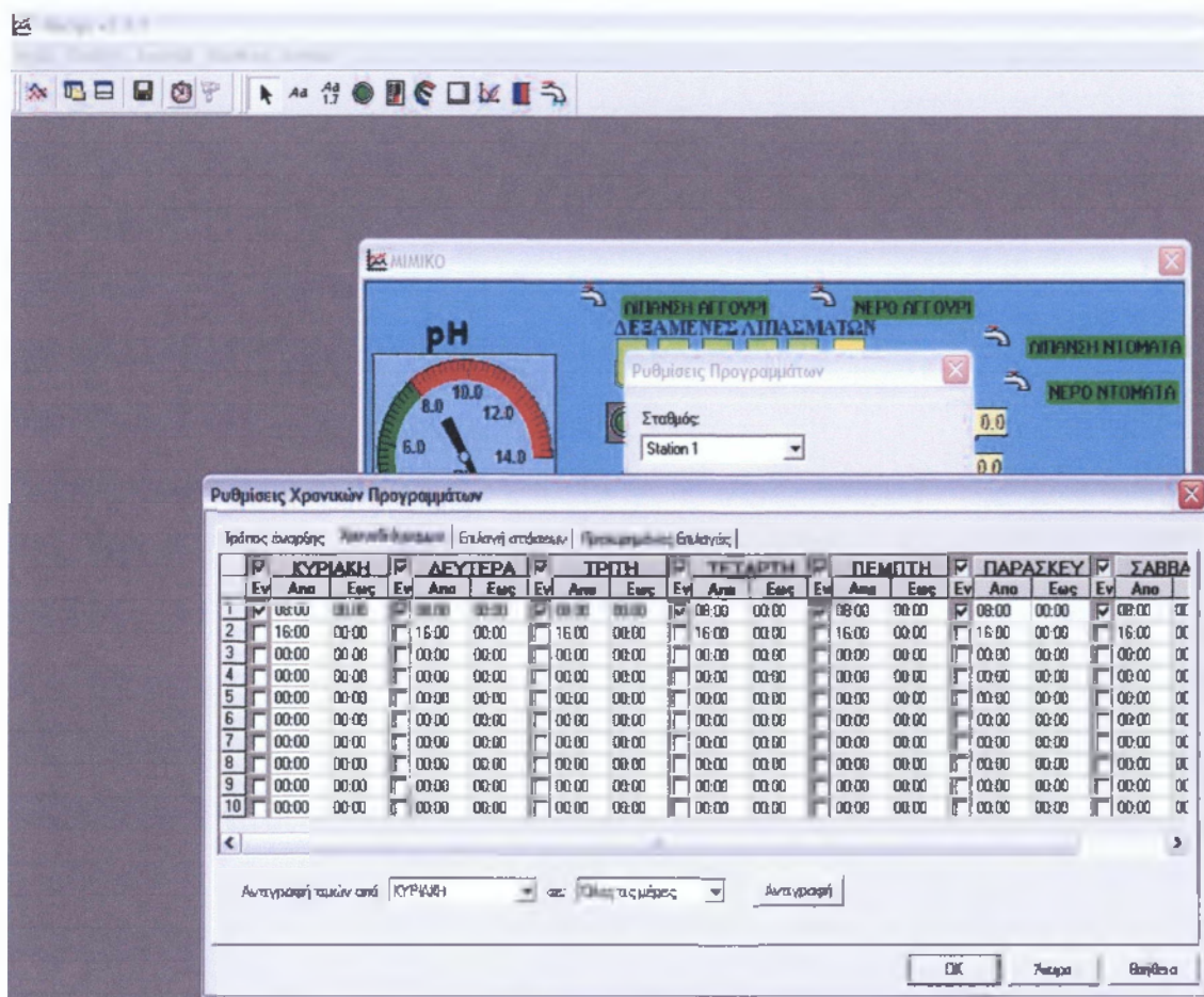
Εικόνα 40: Screen shot από το πρόγραμμα Macqui v.2.3.1 για τη ρύθμιση συχνότητας και διάρκειας άρδευσης
