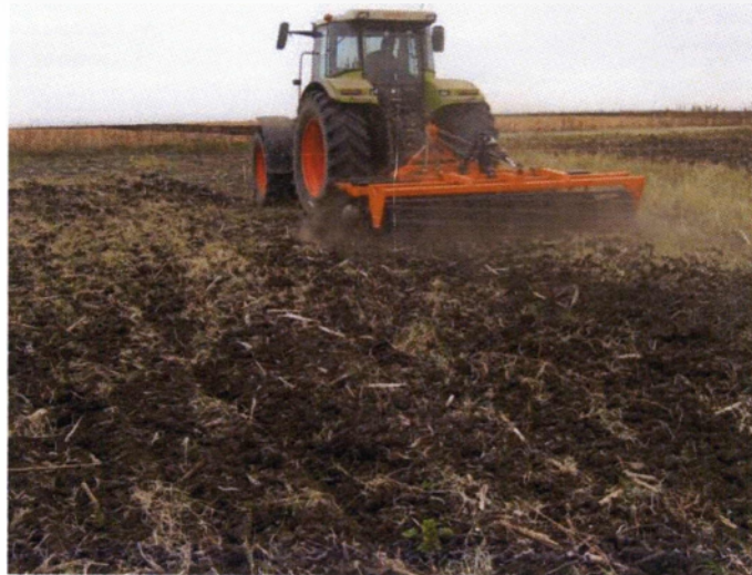
Εικ. 92. Μηχανές για το κόψιμο και τη σύνθλιψη του χόρτου που έχει σαν αποτέλεσμα την γρηγορότερη και ταυτόχρονη, στελέχους και φύλλων αποξήρανσή του. Τούτο ευνοεί την διατήρηση της θρεπτικής τους αξίας. Πηγή: www.buzaka.gr
