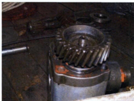
Εικ. 86. Γρανάζια για μετάδοση κίνησης στη φρέζα Πηγή: www.buzaka.gr
