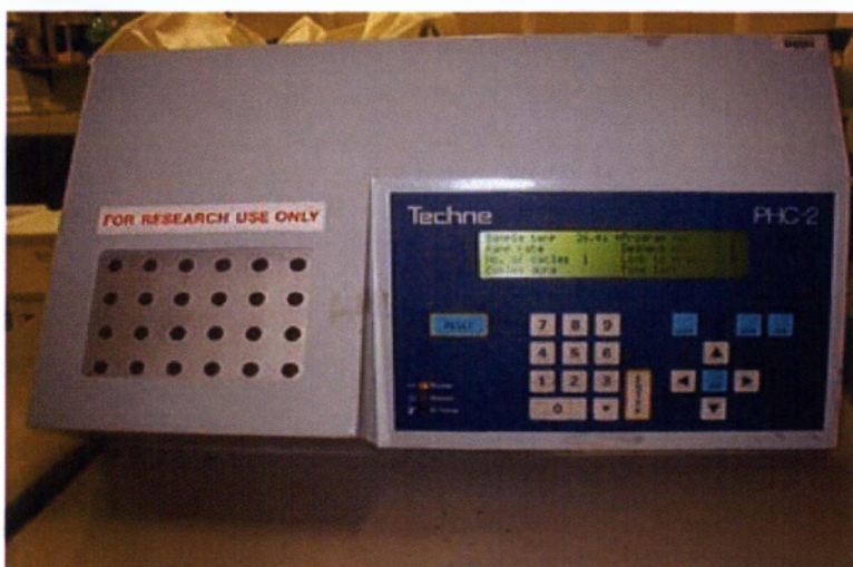
Εικόνα 14:Θερμοκυκλωτής. Πηγή: www.carleton.edu
