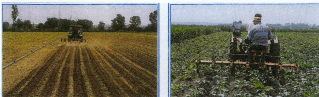
Εικ. 44 . Σκάλισμα τεύτλων με μηχανικά σκαλιστήρια 6 σκαλιστικών σωμάτων (5+2 μισά)
