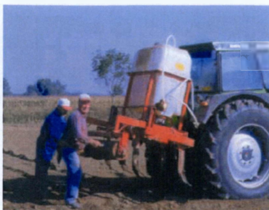
Εικ.73 Εφαρμογή νηματοδοκτόνων στο έδαφος και ταυτόχρονα, σχίσσιμο του εδάφους και συμπίεση αυτού για καλύτερη αποτελεσματικότητα
