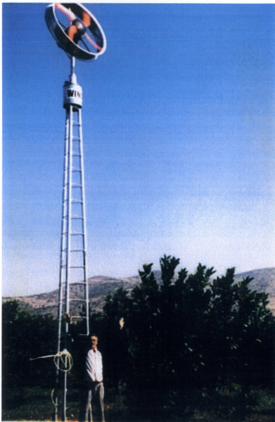
Εικ.9:Αντιπαγετικός ανεμιστήρας στο Ριζάρι Έδεσσας.
